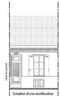
Création d'une surélévation par prolongement de toiture
