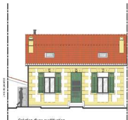
Création d'une surélévation par prolongement de toiture
