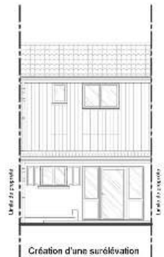
Création d'une surélévation par prolongement de toiture
