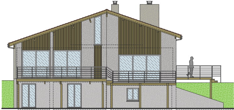
Maison individuelle - Façade sur jardin Transformation de locaux techniques en surface habitable & Modification de façade
